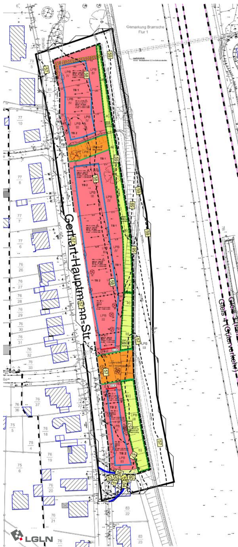
Abbildung 3: Beurteilungspegel tags im ebenerdigen Außenwohnbereich
