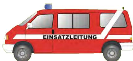
Fahrzeuge der Einsatzleitung, die insbesondere mit Informations- und Kommunikationsmitteln (Alarm- und Einsatzpläne, Gefahrstoff-Nachschlagewerke, Telefon, erweiterter Funkausrüstung, ggf. Fax, PC mit Datenbanken) ausgerüstet sind. Typen der ELW werden nach Norm in Abhängigkeit von der Größe gekennzeichnet mit ELW 1 (Kleinbus, Transporter) bzw. ELW 2 (Lkw oder Abrollbehälter).
