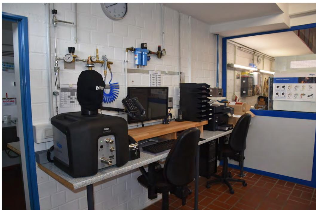
Abb. 7.4-7: OF Bramsche-Mitte: Prüfkopf in der Atemschutzpflgestelle
