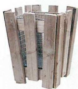
**Abfallkorb L12** mit Holzlaten, gehobelt und Kesseldruckimprägniert. Stahlkorbeinsatz ca. 30 l feuerverzinkt. 540 mm hoch, 340 x 340 mm unten, 430 x 430 mm oben
