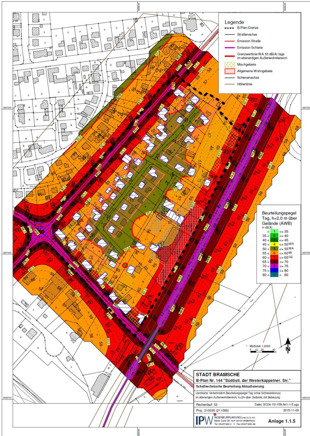
Abbildung 20: Auszug Schallt. Beurteilung – Anlage 1.1.5 – Verkehrslärm Tag am Gebäude
